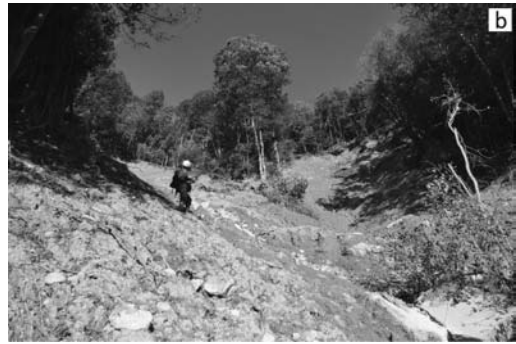
写真-1 a, b 県営緑丘住宅上流の崩壊頭部 (a) と頭部全景 (b)。表層崩壊，岩脈（斑状流紋岩）が露出する。
