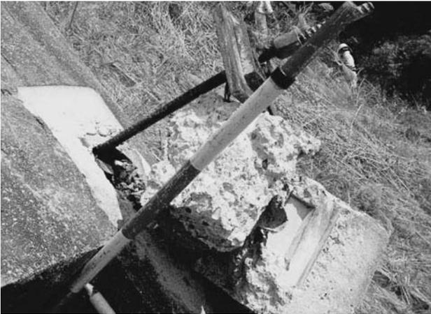
写真-11 破砕された頭部調整コンクリートと抜け出た tendon
