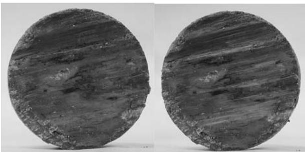
写真-10 すべり面の接写撮影例
