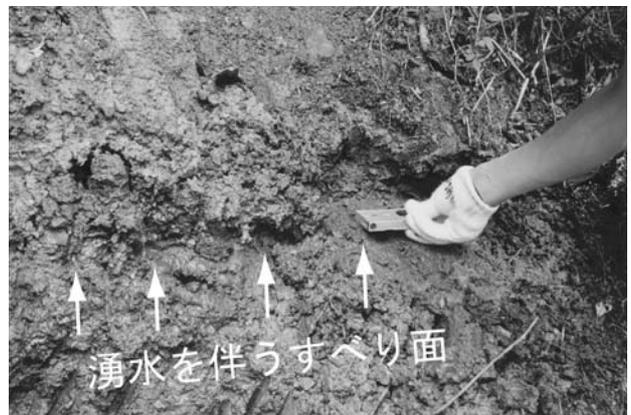
写真-6 斜面途中に見られる湧水を伴ったすべり面。
