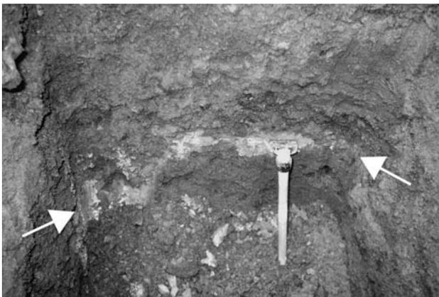
写真一 地すべり末端部のバックホー掘削で確認されたすべり面。すべり面は白色の凝灰岩質な粘土（秋田県島海町）
