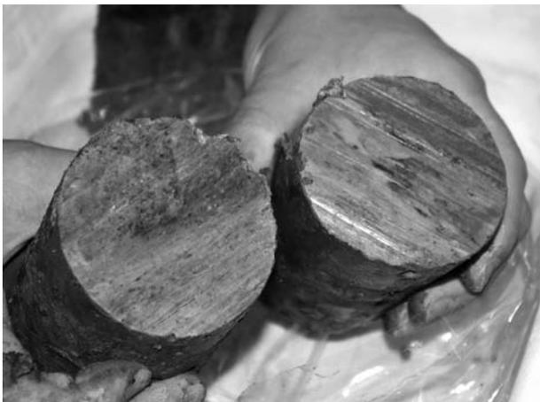
写真-9 すべり面の接写撮影例
