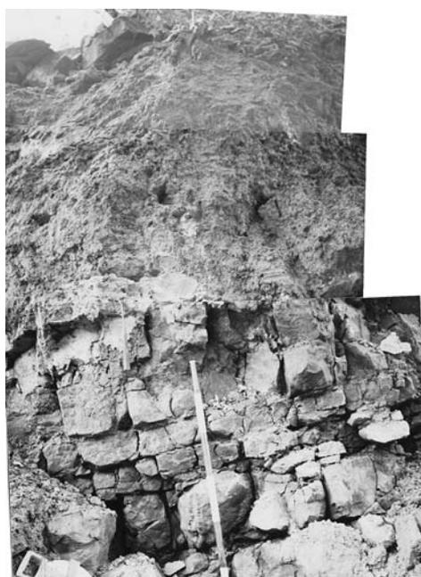
すべり面は写真下部よりさらに1~2m深部の凝灰岩薄層に形成されている。
