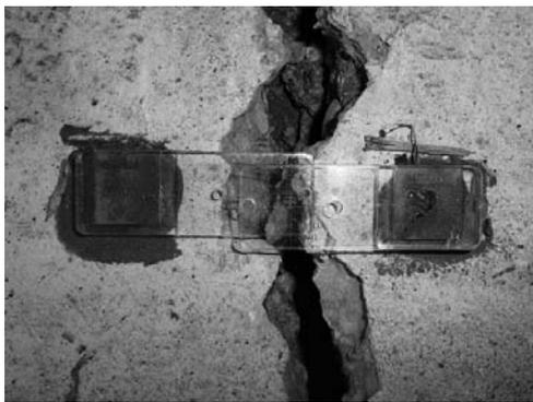
写真4.1.1 亀裂変位の計測
