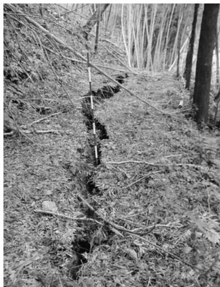
写真-1 段差を伴う開口亀裂(地すべり頭部)
