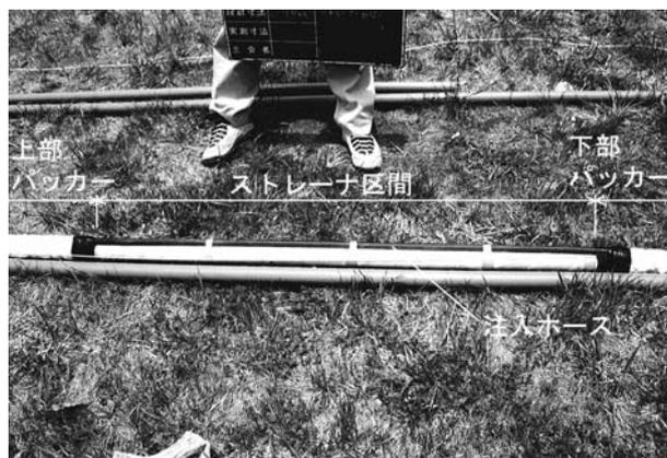
写真8 パッカー式地下水位観測専用孔
