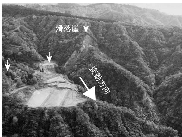
写真-1 2004新潟中越地震時に尾根部が移動した一ツ峰沢の岩盤地すべり（高橋ほか，2005）を一部改変，撮影：原口強（2004年）
