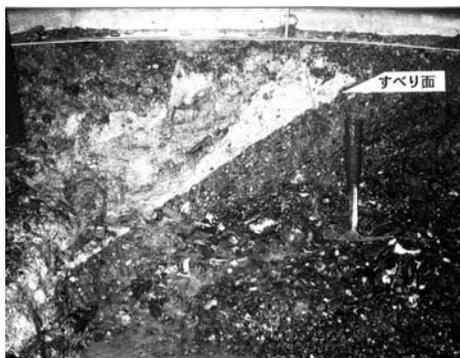
写真-4 集水井壁面に現れたすべり面（徳島県水のなる地すべり）
