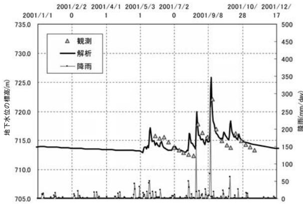
図-8 降雨時の地下水変動の再現結果
