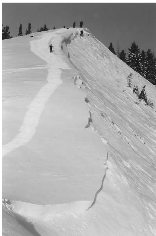
写真－5 人工的に起こした面発生乾雪表層雪崩発生後の斜面
