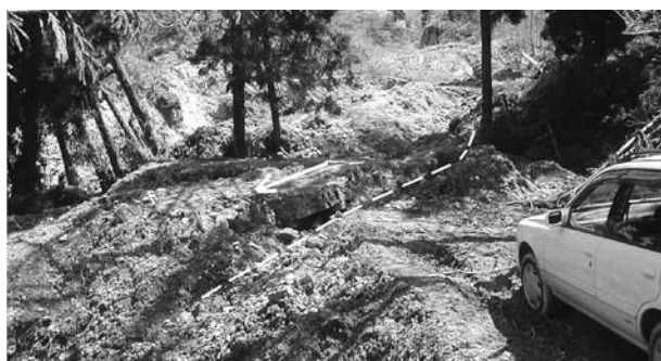
図-2 円弧すべりの回転運動による変形
