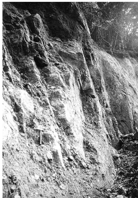
写真一 3 滑落崖を規制する節理系の例
