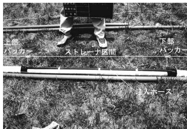
写真-8 パッカー式地下水位観測専用孔
