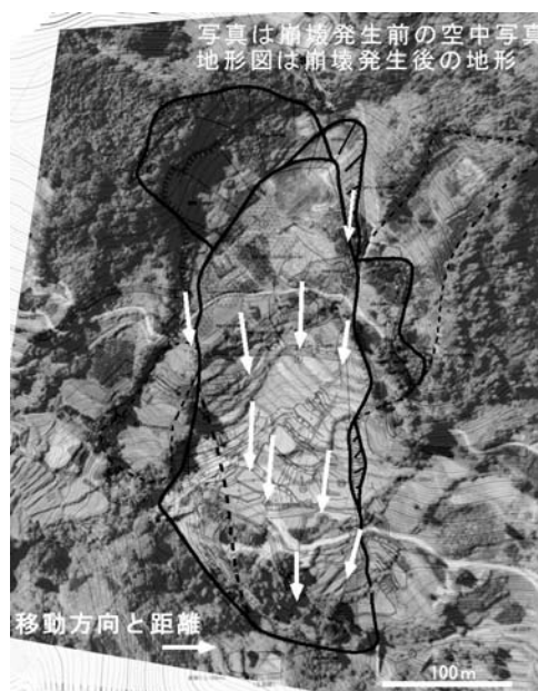
写真-5 空中写真による指標物の移動判読例
