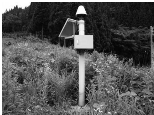
写真4.1.2 連続観測用GPSの設置例
