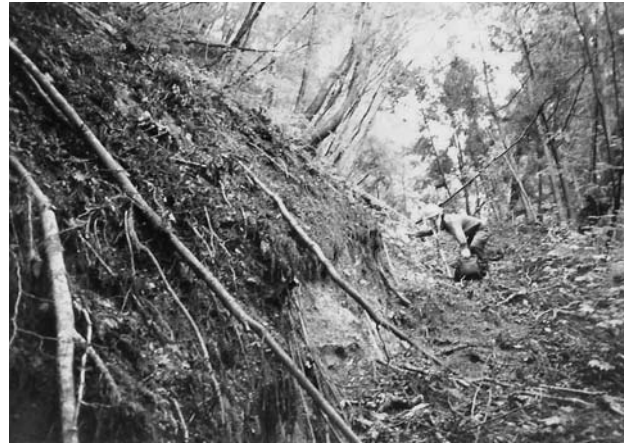
写真-22 滑落崖の長期的な変位に対応して成長した樹木の根
