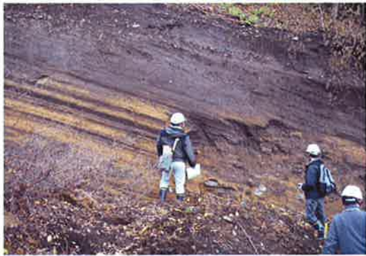
写真 11 側方崖に形成された地すべり擦痕
