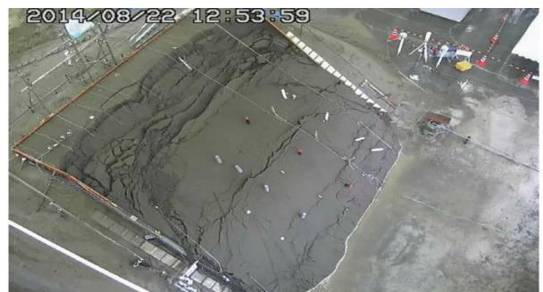
図5 崩壊後の土塊形状
