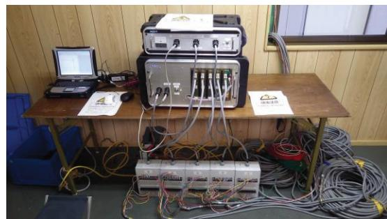
写真 2 比抵抗モニタリングシステム
