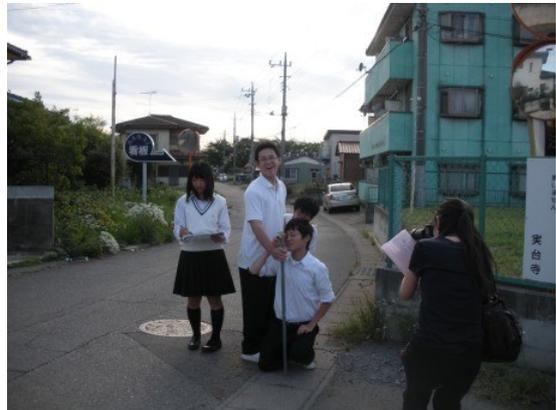
上の写真は、科学部の生徒達が学校周辺で測量を行っている様子である。ハンドレベル・メジャー・1mの塩化ビニール管を工夫して使って測量している。そして、測量の値と地形の様子から、1m毎の浸水域を決定して、地形図に色で示す。このような活動を週に2~3回のペースで行っている。
