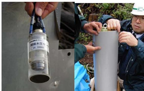
図-4 間隙水圧計
