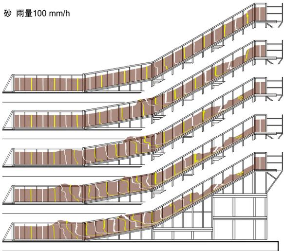
図5 崩壊後の土砂流下挙動の読み取り図 (t=0(図4)の時を始点に1sごとに)
