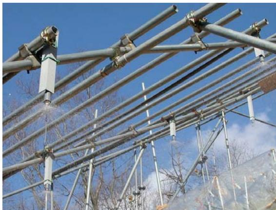
図-3 人工降雨装置の散水ノズル
