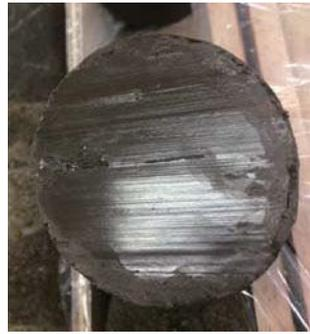
写真3 ボーリング調査で確認されたすべり面(H30B-2孔: GL-51.7m)
