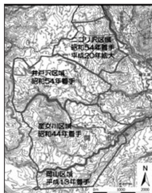
◀図1 磐井川地すべりの事業区域(1688haと非常に広大、平成20年に市野々原地区で発生した地すべり地も拡大した)
