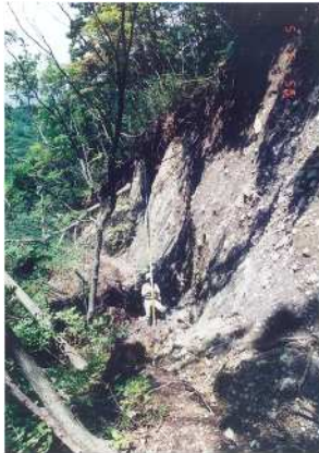
図 22 1) (左) 頭部滑落崖(9月5日). 落差は10 m 余りで、末端部の水平移動量にほぼ匹敵している.
