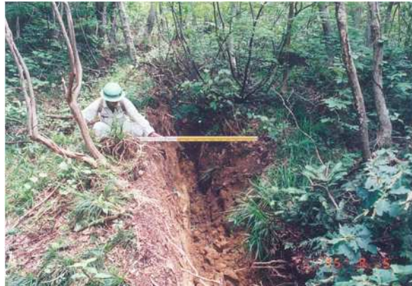
図 22 1) (左) 頭部滑落崖(9月5日). 落差は10 m 余りで、末端部の水平移動量にほぼ匹敵している.
