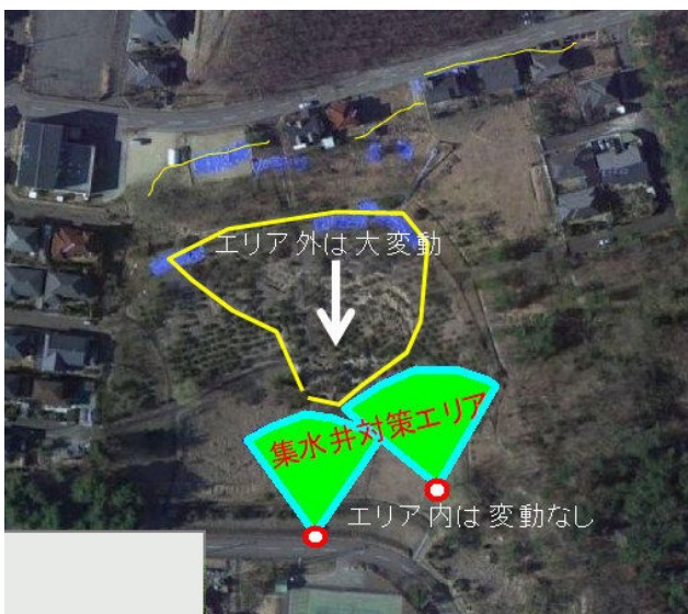
写真5 集水ボーリング到達域は変動せず
