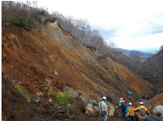
写真3 南方に押し出した地すべり土塊の末端部
