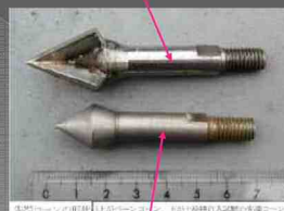
土層深を測定する先端コーン
