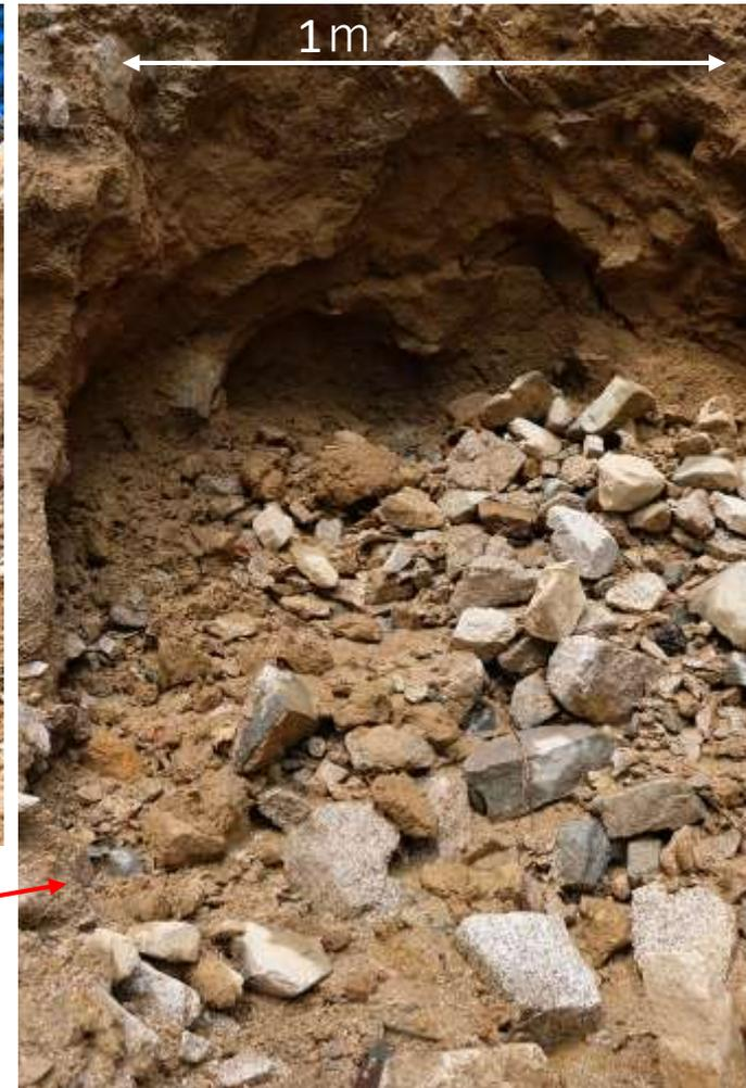
深い地下水での異常な水圧上昇が、崩壊の主な原因？
