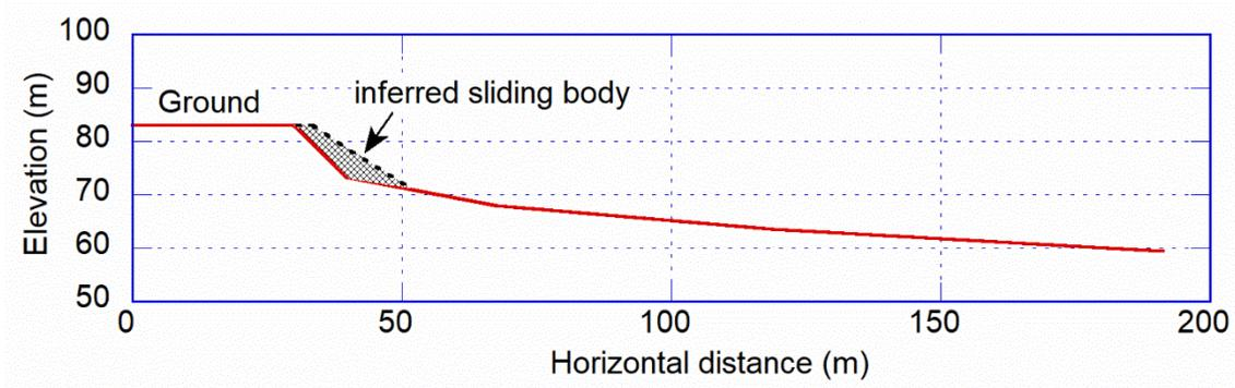
図2：沢の源頭部における断面図および推測した地すべり土塊
