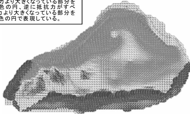
図-6 滑動力-抵抗力バランス図
