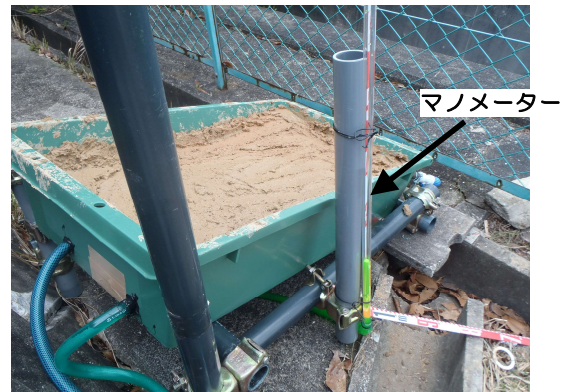
図-3 土槽の裏側から接続したマノメーター
