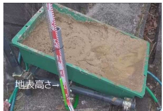
図-5 模型実験状況（写真の矢印の位置が地表高さであり、染料を混入したマノメーターの水位は、その地表高さより最高 4cm 程度上まで上昇した。）
