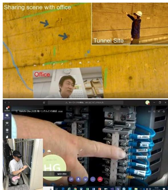
図-8 トンネル調査[上]と電力施設の点検[下]における遠隔支援の実施状況
