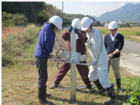
サンプルボックス、シャッタープレートの順にバイブレータで打ち込む (女性でも作業可能)
