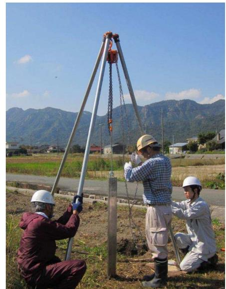
三脚とチェーンブロックを用いて地中から引き抜サンプラーを引抜き、土を採取
