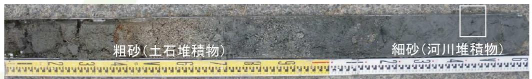
ジオスライサーによる連続採取試料 (GS-10) と含有炭化物
