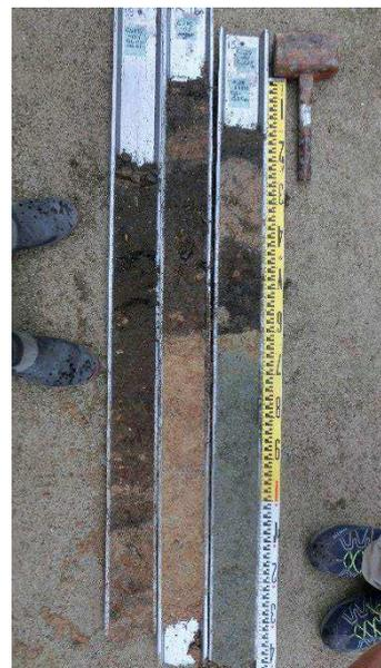
抜き取った地層から年代測定用の炭化物試料を採取する
