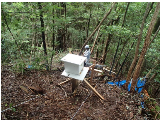
写真-9 開口亀裂と伸縮計③
