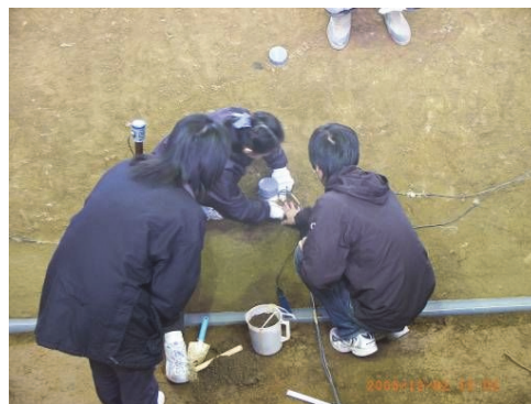
図5 データの無線転送（受信側）と試作したセンサーユニットの設置
