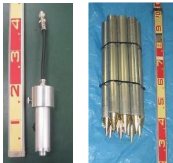
(a) IT 傾斜計 (左) と 打込パイプ (右)
