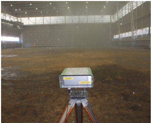
写真-5 降雨実験状況（左：設定降雨量 200mm/hr、基線長 30m、右：設定降雨量 120mm/hr、基線長 62.5m）
