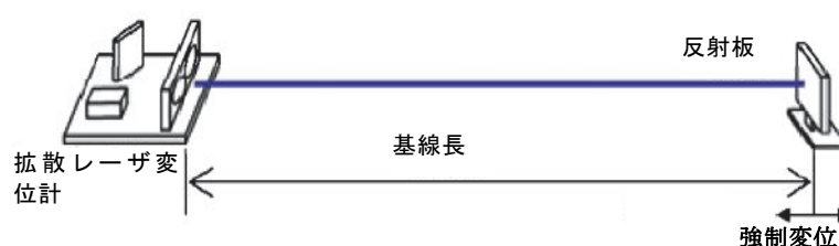
図-4 室内精度実験における拡散レーザ変位計の計測システムの設置概要図
