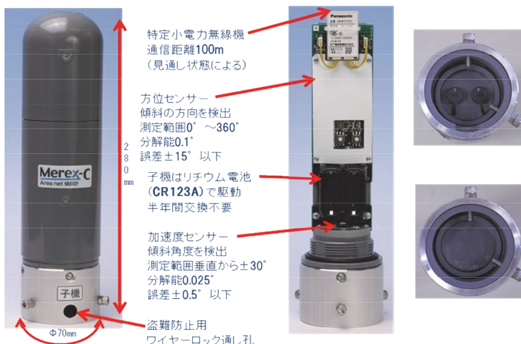
写真-8 Area net 傾斜計 機器構造
