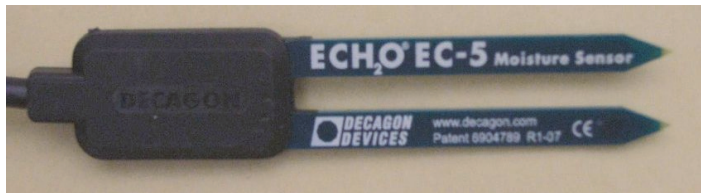
図4 土壌水分の計測（上：セラミックカップによるサクション計測、 下：誘電率の変化による体積含水率計測）
