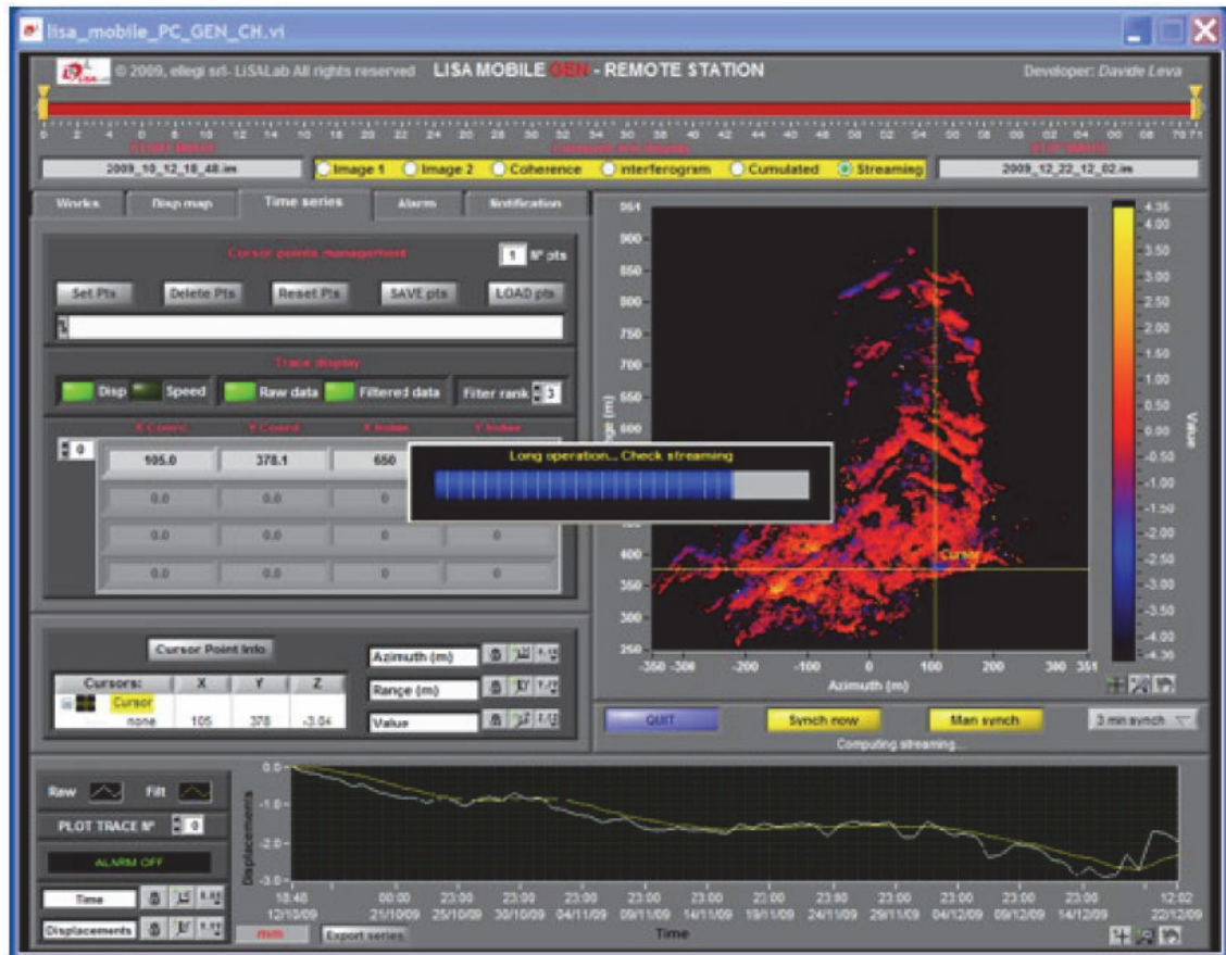
図-4.1 現場の PC で表示される面的変動量図と指定地点の経時変化図例
