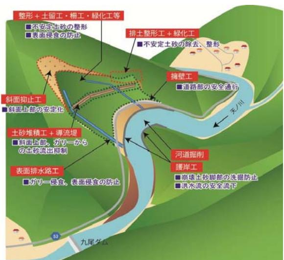
図-7 深層崩壊斜面对策の事例（坪内）
