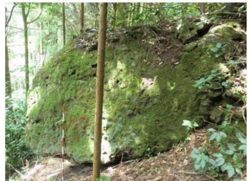
写真-6 最も大きい浮石 (直径4mを超える)
