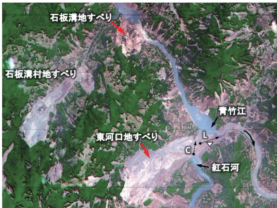
写真-7 東河口付近の地すべりと地すべりダム(黄潤秋より)。東河口地すべりにより、青竹江およびその支流である紅石河が堰き止められた。石板溝地すべりが青竹江を堰き止め、唐家山地すべりダムの次に、2番目の大きい堰止め湖が形成された。C, L:表面波探査測線; ▽:微動アレイ観測位置。
