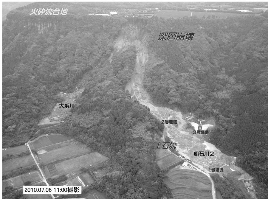
図-5 南大隅町舟石川で発生した深層崩壊と土石流（鹿児島県，2010）
