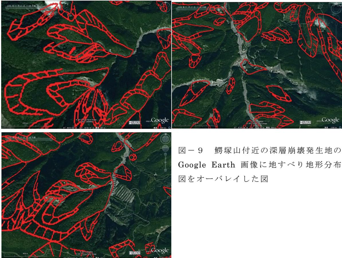
図－9 鱈塚山付近の深層崩壊発生の地の Google Earth 画像に地すべり地形分布図をオーバーレイした図
