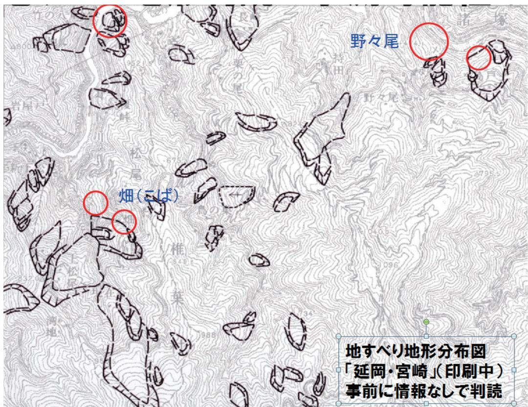
図一六 耳川流域の地すべり地形分布図と台風 14 号で崩れた斜面 (赤丸)
