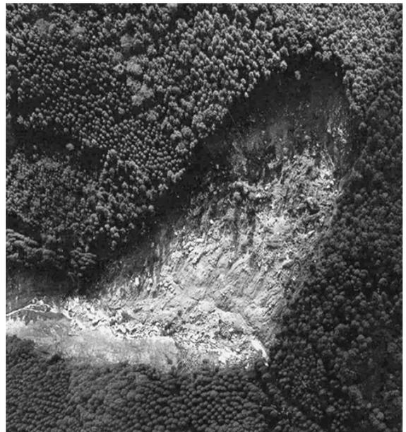
図一2 水俣市集川で発生した深層崩壊と土石流(撮影:アジア航測(株))
