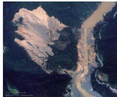
図-3 2005 年台風 14 号によって耳川沿いに発生した大規模崩壊<sup>27)</sup>。上は発生前後のスケッチ。崩壊前にその上縁に沿って小崖があった。下：アジア航測撮影
