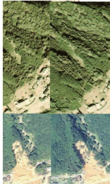
図-2 宮川豪雨災害の崩壊箇所(里中地区, 上: 国土地理院 1975年撮影; 下: 中日本航空: 災害直後撮影). 崩壊の両側が断層で切断されている。
