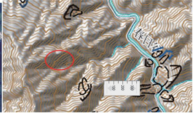
写真－1 宮川村春日谷左支の崩壊（アジア航測） 図－4 同じ範囲の地すべり地形分布図
