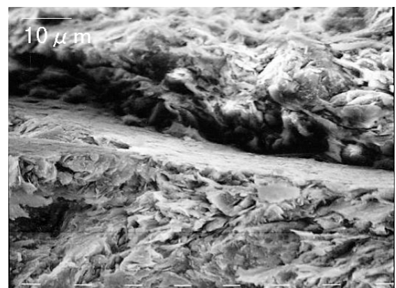
図-1 6 同左試料のリングせん断試験後 せん断面を断面方向から観察した状況
