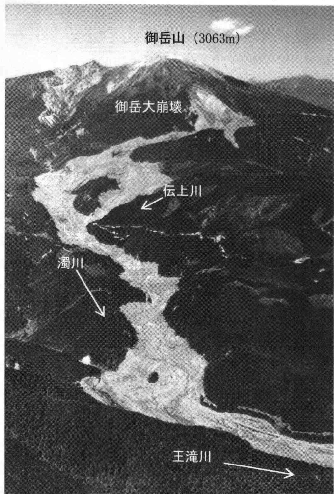
図3.5 長距離にわたり流動化し王滝川に流出した崩壊土砂（1984、王滝村役場農林建設課提供）
