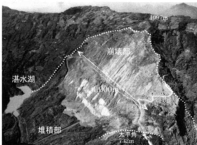
図 3.8 九分二山崩壊の斜め写真（左下にもう一つの湛水湖がある。堆積部は幅、長さ共に約 1,000m。2000 年 12 月撮影）
