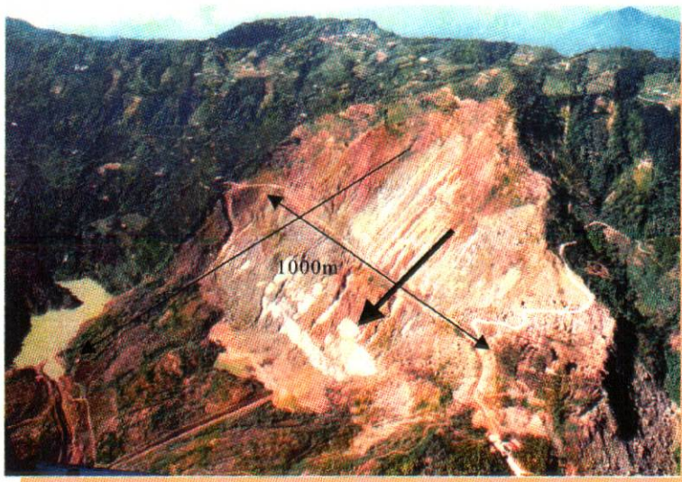
写真－4 九分二山大規模地すべり性崩壊（2000 年 12 月 17 日撮影） 崩壊規模は、幅約 1,100m, 斜面長約 1,000m, 平均厚約 80~90m で、崩壊土量は約 9,300 万 m 3 である。左下方には崩土により形成された天然ダムが見える。堆積面上には排水路も見える。
