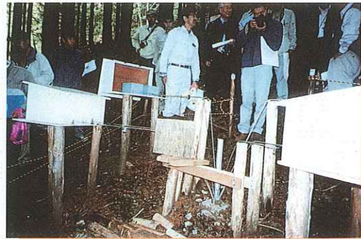
孔内傾斜計と伸縮計群
