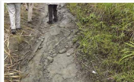
滑落面(すべり面)の砂質泥岩シート粘土が挟在している(草嶺地)
