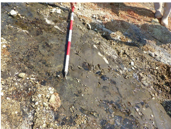
写真 5.3.9 すべり面の条線
