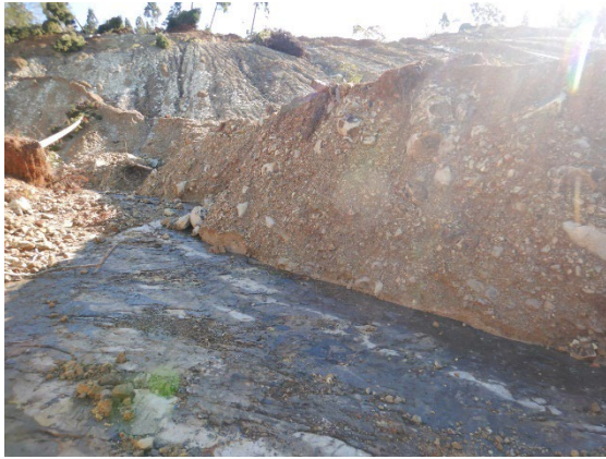
写真 5.3.5 基盤岩及びすべり面の露出 地すべり土塊と基盤岩の明瞭な風化、透水性の相違が認められる。
