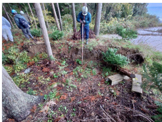
写真 5.1.6 地すべり頭部滑落崖（左）と側部の亀裂（右）
