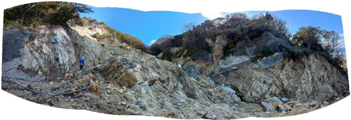
写真 5.1.15 崩壊の原因（地震、土石流）の区別が困難な現場状況と岩質
