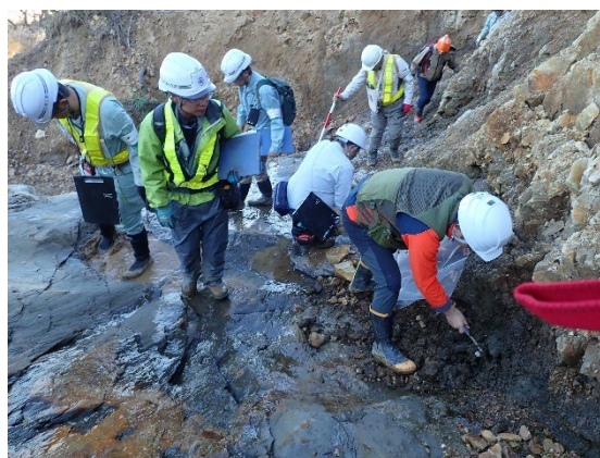
写真 5.3.12 すべり面の露出箇所の近景 湧水が認められる。
