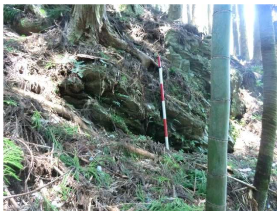
写真 9 地すべり地形 B の側方崖
