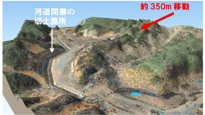
航空レーザ測量による 3D モデル
