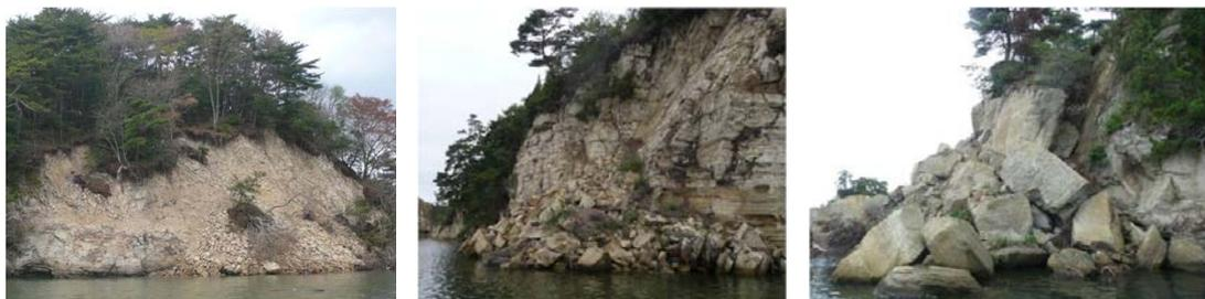
写真-1 左 風化・破碎の進んだシルト岩の崩壊，中 節理・層理間隔数十 cm のシルト岩の崩壊，右：節理・層理の発達しない塊状軽石凝灰岩の崩壊
