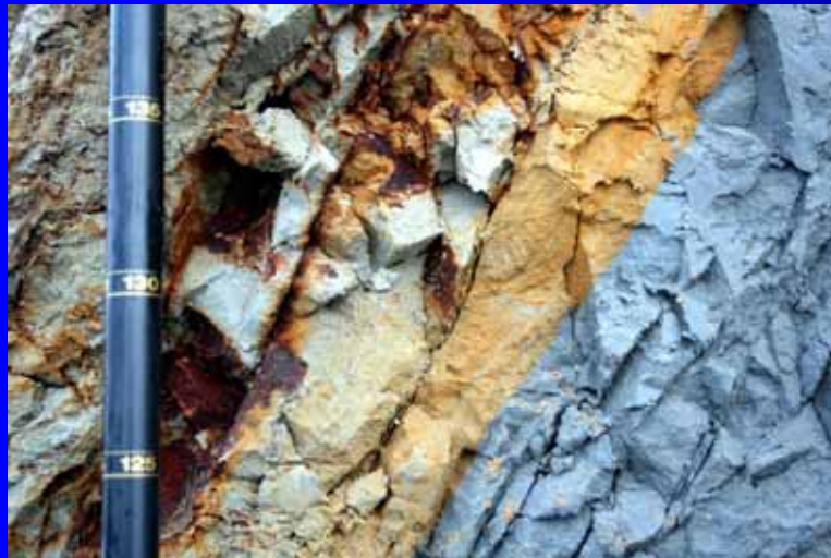
頭部滑落崖に露出したシルト岩の風化状況
