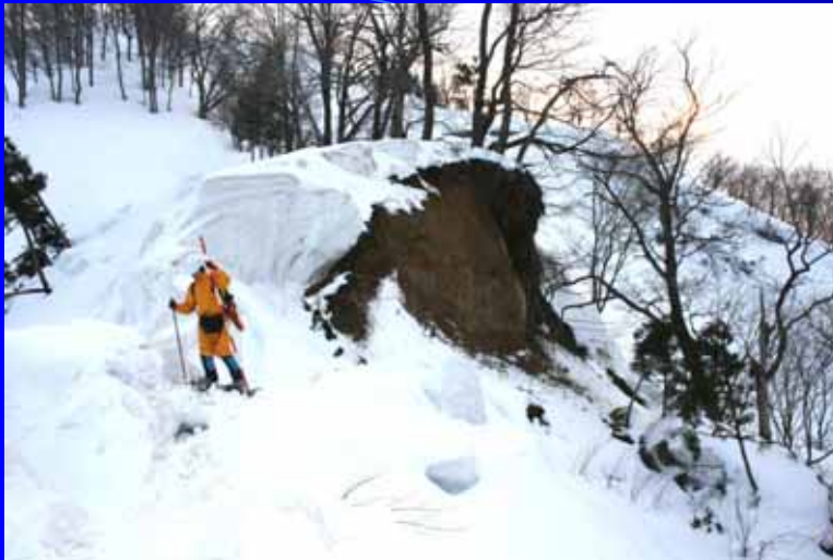
東側から見た頭部滑落崖。後背斜面に亀裂は見られなかった。
