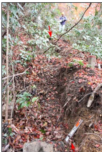
写真8 鮫川の左岸側斜面で観察された 地表地震断層（写真左が西、下盤）
