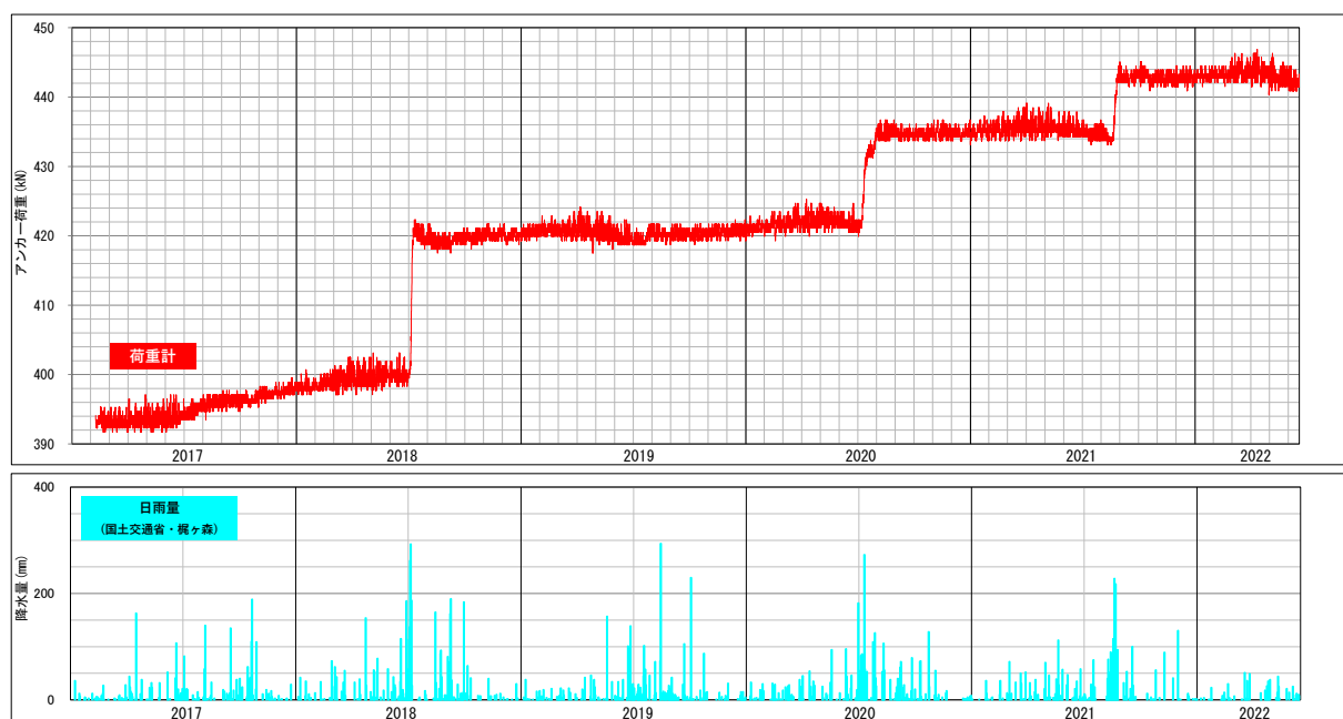
図-7 アンカー荷重観測結果と降水量
