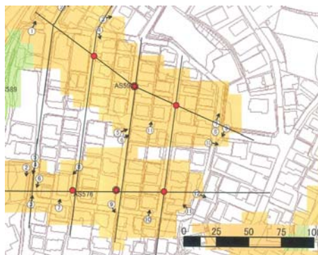
図 14 ボーリング孔の配置 (例)
