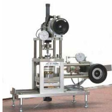
図-1 すべり面せん断試験機 (繰り返し一面せん断)
