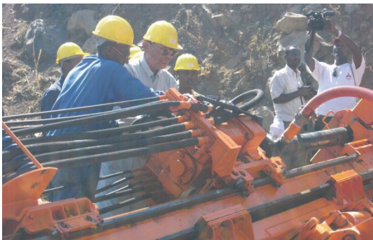
写真-8 水平ボーリングマシンの操作指導風景
