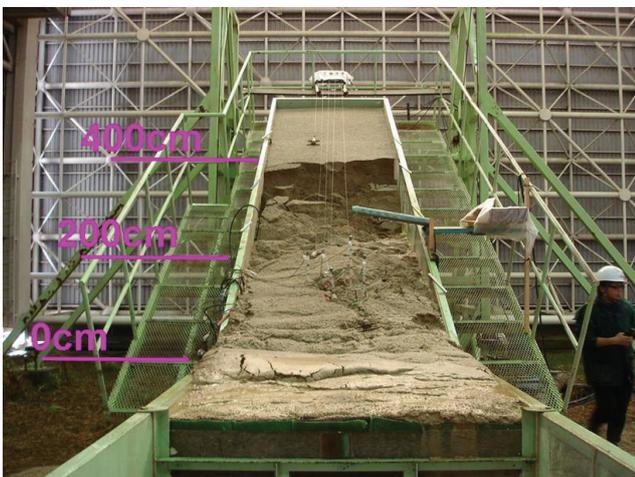
写真-3 崩壊後の模型斜面（正面）
