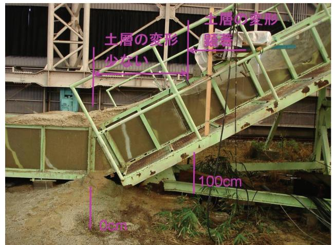
写真-4 崩壊後の模型斜面（側面）
