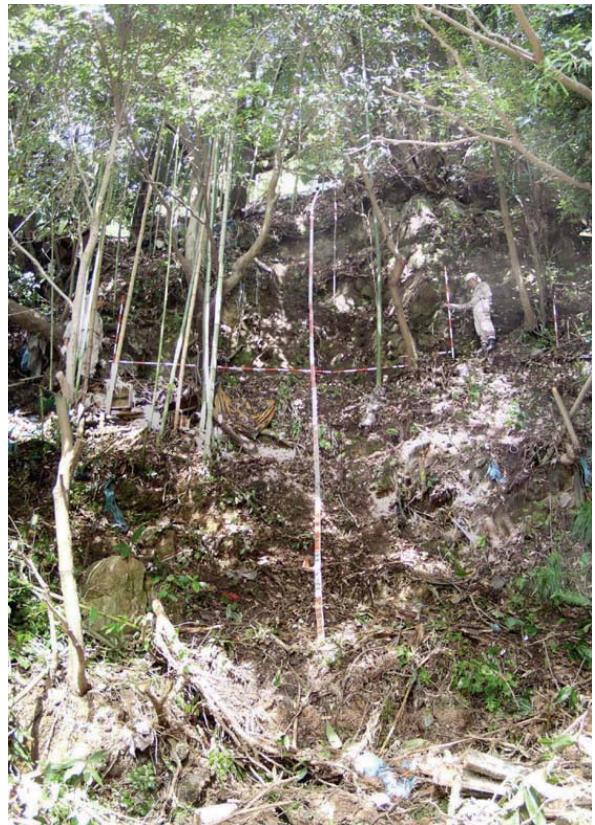
写真-16 国道直下の变成泥岩露頭
