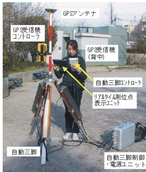
図-10 RTK-GPSを用いた斜面定期健康診断用の移動局側試作システム。一人ないし二人で観測が可能。
