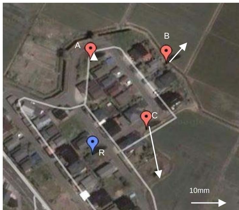
図— 2 1 柏崎市上田尻地区池が峰住宅地の空中写真 ( Google Map , 上が北 ) および静止 GPS 連続観測点の配置 . 青点 (R) は基準点 , 赤点 (A, B, C) は移動観測点 . 擁壁が倒壊しかけたのは A 点の北側 . 白矢印は平成 19 年 8 月から 3 月までに得られた水平移動ベクトル .
