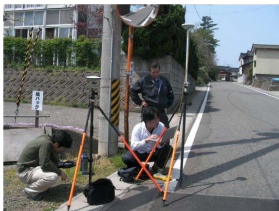
図 - 1 7 番神地区での RTK-GPS による移動観測の状況(測点 E) .
