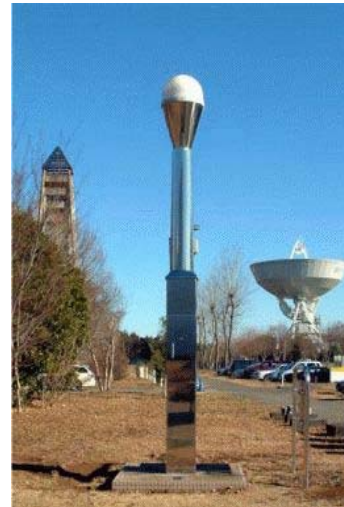
図 - 1 RTK - GPSの原理(左)と国土地理院が設置している基地局
