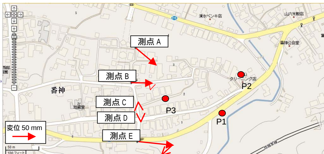
図 - 1 3 番神地区の住宅地図，GPS 測点の位置(Google map)，RTK-GPS で計測した移動ベクトル → (2007 年 8 月～2008 年 4 月)，→ (2008 年 4 月～2009 年 3 月)。
